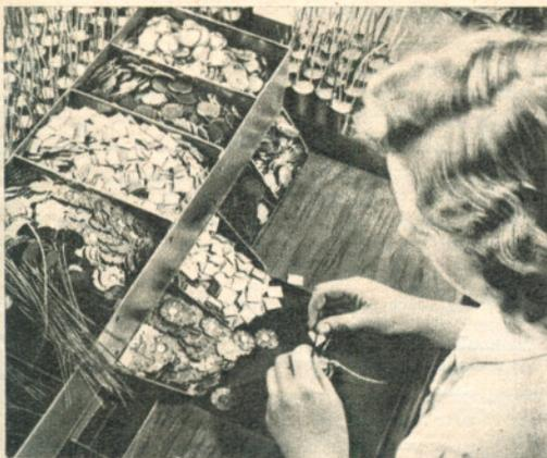
Trockengleichrichter verschiedener Firmen sind in vielen der neuen Rundfunkgeräte eingebaut. Das Bild zeigt einen Einzelarbeitsplatz in der Montage von AEG-Selengleichrichtern. Werkaufnahme
